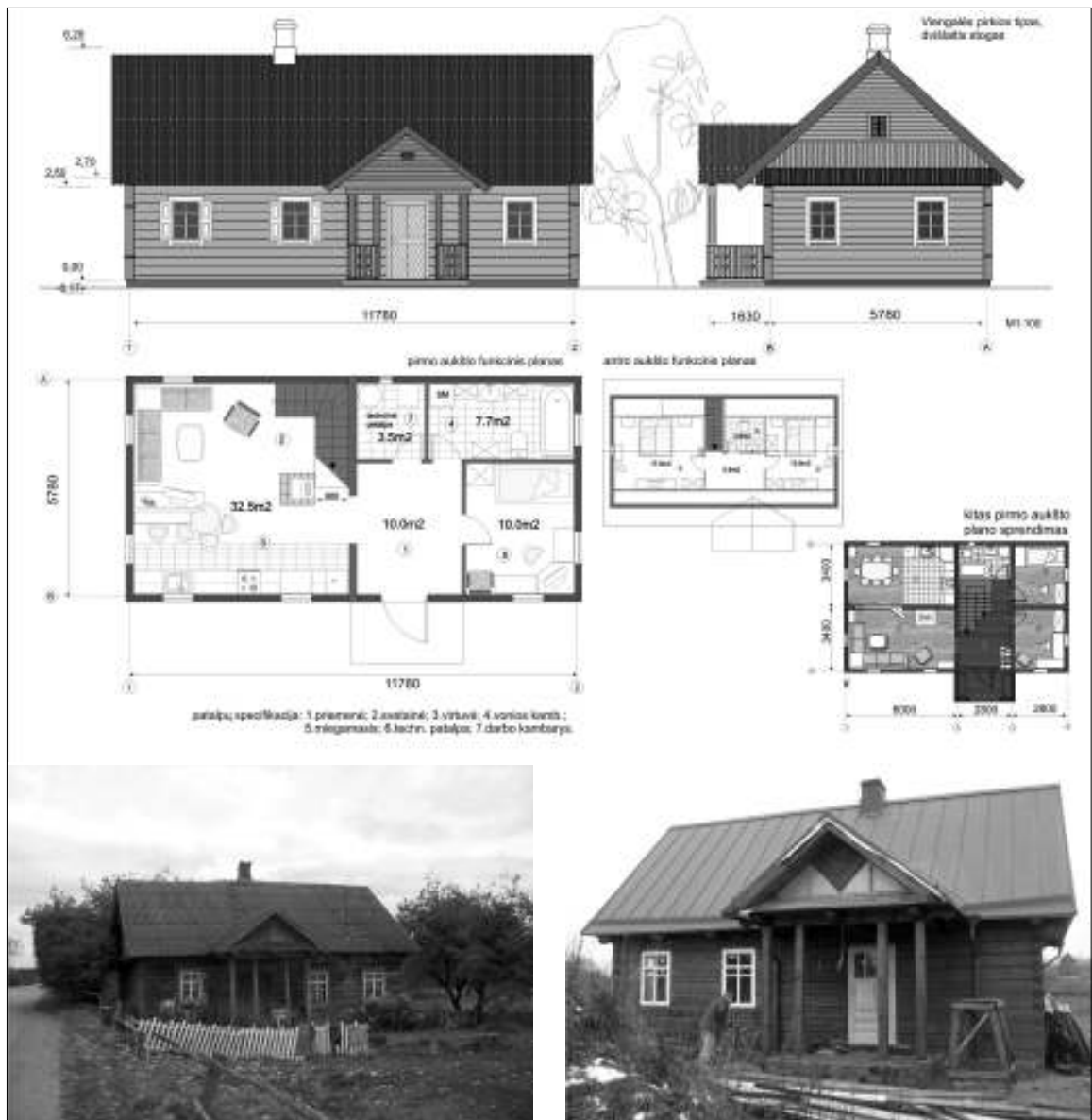
Viengalės pirkios projektas, parengtas pagal dar stovinčio prototipo apmatavimus. Statinio išplanavimas visiškai pakeistas ir pritaikytas šiuolaikiniams poreikiams. Arch. N. Norvaišaitė, 2006 m.
